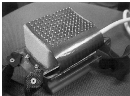
شکل ۱-۲: آرایه ۱۲۸ عددی الکترودهای EMG سطحی (Zwarts M.J., 2003)
